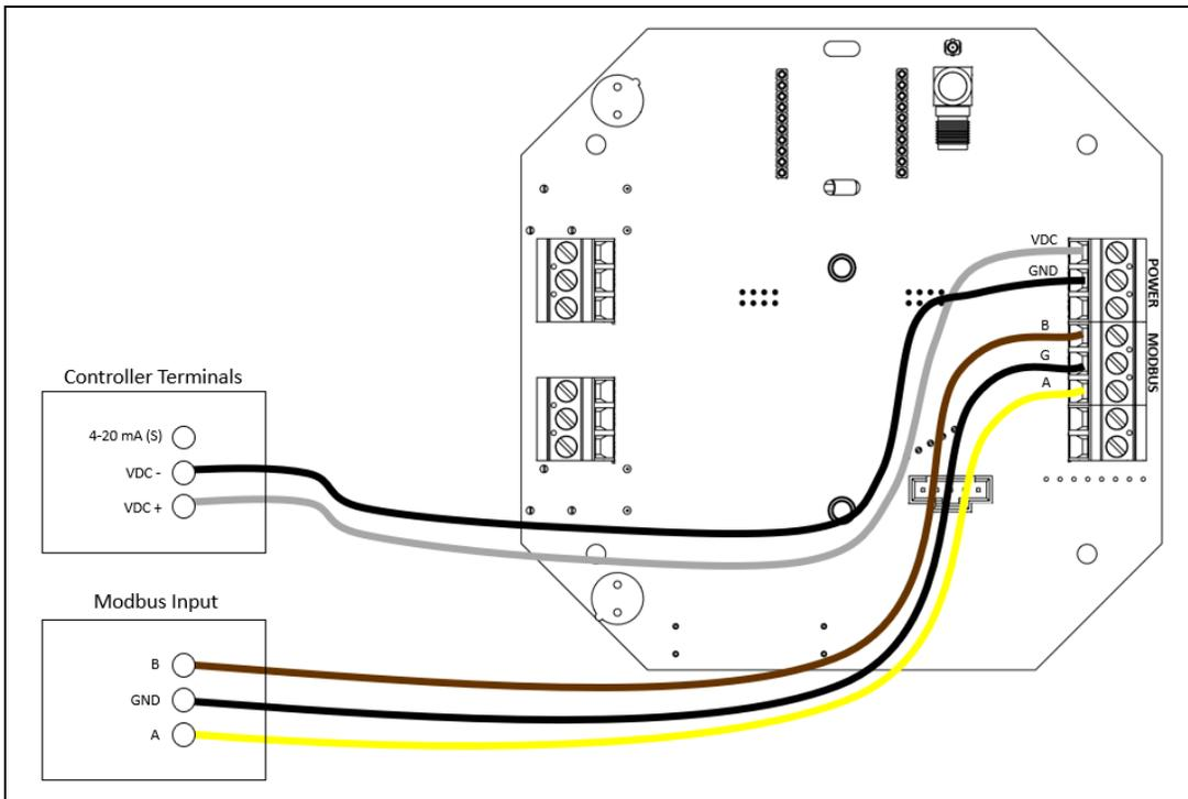
**Figure 17: Modbus Wiring, Relay Version**
